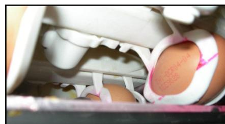
一把风刀，将要喷印编码的蛋品表面区域烘干。调整风刀气压以在不损坏蛋品的情况下达到最佳干燥效果。过高的气压可能会使一个完好的蛋品破裂，导致蛋品漏液流入包装系统的其余部分。
