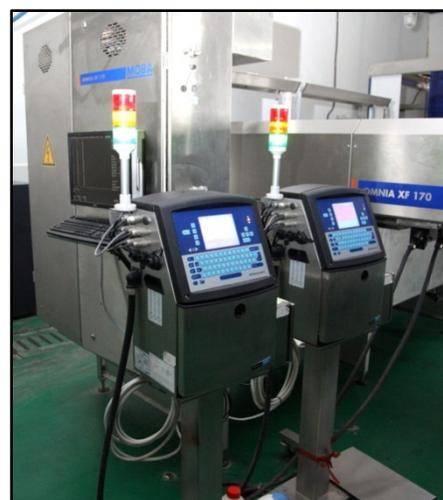
从速度、空间和环境角度来看，此位置也最具挑战性。分级机速度为 45 米/分钟时，喷码机在每枚蛋品上喷印的速度约为 40 米/秒钟，无论是从端到端喷印还是在蛋品顶部喷印。此时，CIJ 喷码机可以喷印两行文本。
