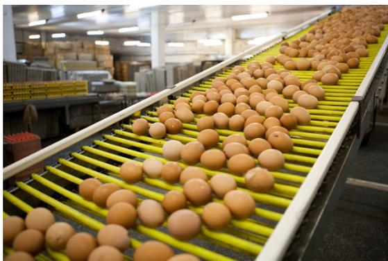
维护要求与喷码设备的位置和清洁流程息息相关。在线蛋品喷码位置紧接输送区域的下游部位，此处可能是最脏的区域，分级机通常在此排出蛋品，有时蛋品从夹具中滑出，水和蛋液经常会滴出来。至关重要的是制定操作流程，确保周边的蛋屑不会干扰喷码过程、妨碍对其他蛋品正确
