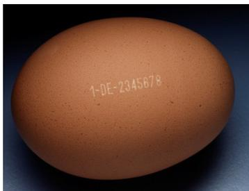
尽管大多数蛋品喷码采用喷墨解决方案，但基于激光打码的解决方案也是您应该考虑的一个备选方法。相比喷墨喷码而言，激光打码拥有两大优势：激光在标识蛋品时不消耗墨水，丝毫不受水分的影响。激光标识过程是通过精细烧蚀蛋品表面，改变蛋壳颜色来实现的。激光打码在褐色和白色
